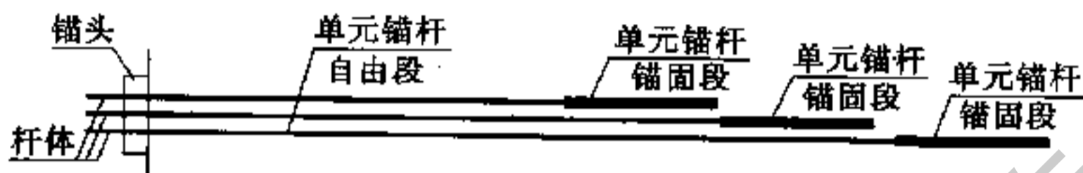
图 4.3.1 荷载分散型锚杆结构原理
