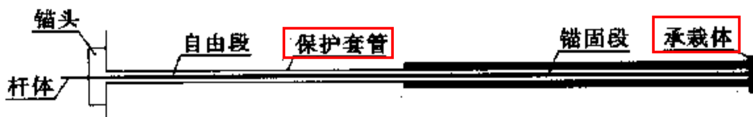
图 4.2.2 压力型预应力锚杆结构原理
