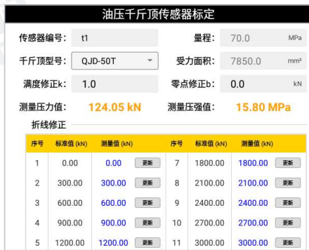
图 3.37 压力传感器千斤顶标定
